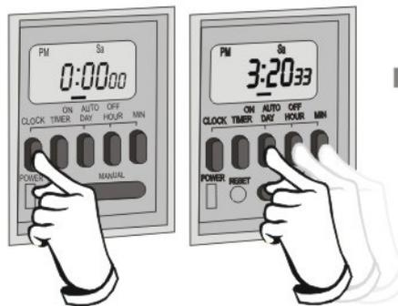
2). Programación de tiempos de encendido y apagado: Pulse el botón "TIMER" para ingresar al menú de programación; en este visualizará paso a paso las 8 programaciones de encendido y apagado que se pueden memorizar. En principio visualizará la primera programación de encendido (1 ON) para lo cual deberá pulsar los botones "DAY", "HOUR" y "MIN" y así ajustará el día ó los días en que usted quiera que el contacto de salida cambie de estado.
