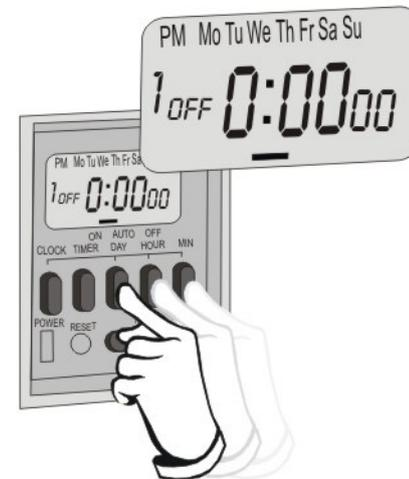
Cuando haya terminado de memorizar las programaciones de encendido y apagado, pulse el botón "CLOCK" para volver a la pantalla principal. Si desea modificar la hora de cualquiera de las programaciones, bastará con pulsar el botón "TIMER" y ubicar la programación que requiere cambiar, después de ubicada pulsará los botones "DAY", "HOUR" y "MIN" hasta ajustar el horario deseado, seguidamente pulsará el botón "CLOCK" para volver a la pantalla principal.
